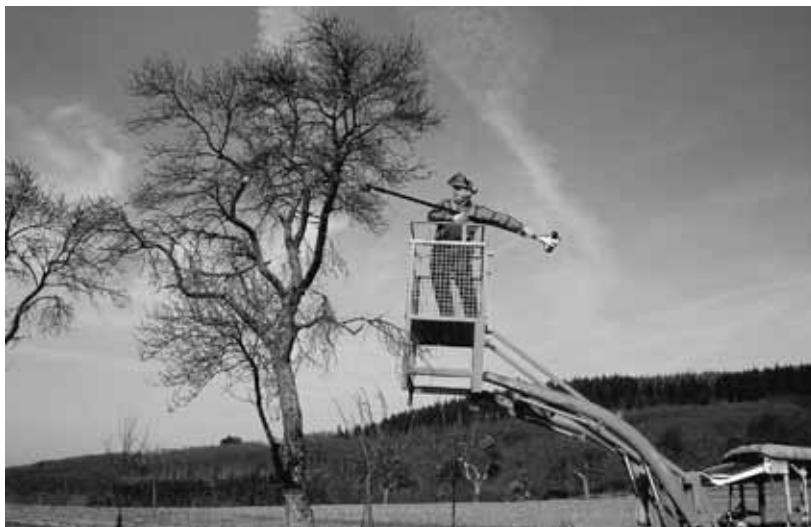
Kostengünstige Alternative zu einer Hubarbeitsbühne: Arbeitskorb am Schlepperfrontlader
